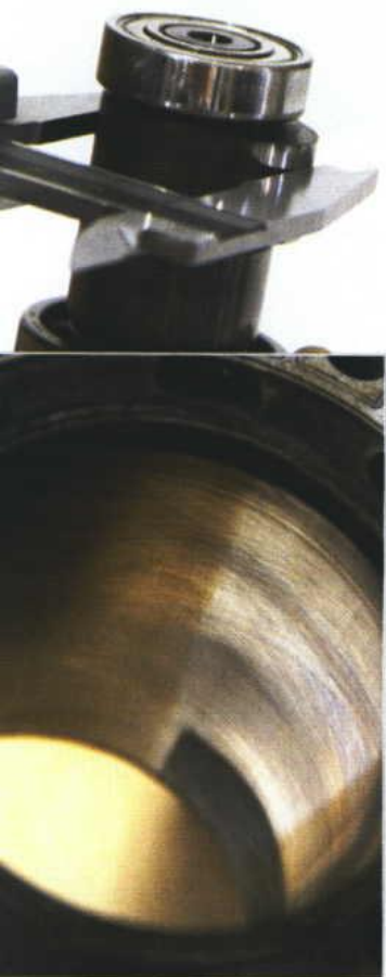
SEM DESGATE, NEM RISCOS: MARCAS DO BRUNIMENTO AINDA ESTAVAM NO CILINDRO
