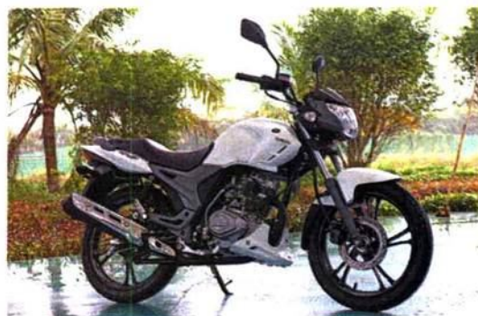
As rodas são de liga leve, com aro de 18 polegadas. O visual é atual e conta com limpa-trilhos sob o motor
