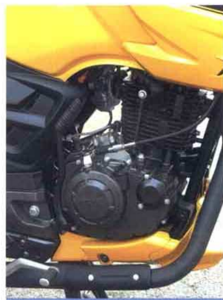
O OHC monocilindro refrigerado a ar é capaz de 14 cv a 8 mil rpm e 1,27 kgf.m de torque a 6 mil rpm. Respeita os índices de emissões, mesmo sem injeção
